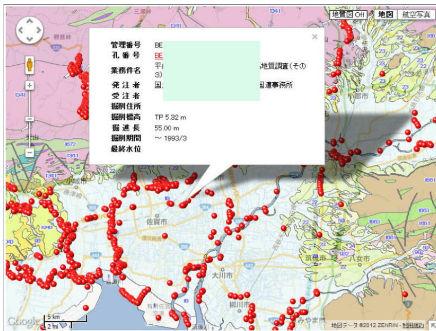
ボーリングマーカーをクリックするとメタデータを表示する(例) —GUPI ボアホールマッピングシステム—
